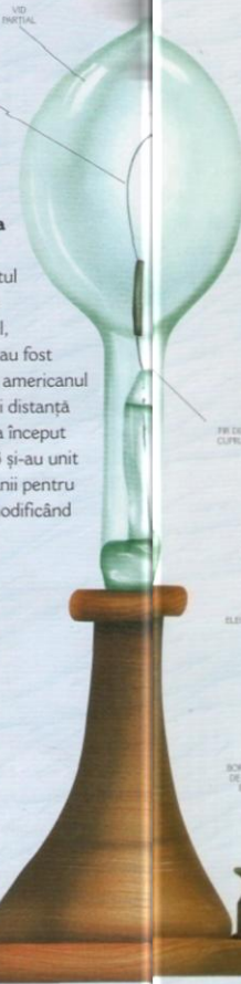
FILAMENTUL BECULUI DIN BUMBAC CARBONIZAT
