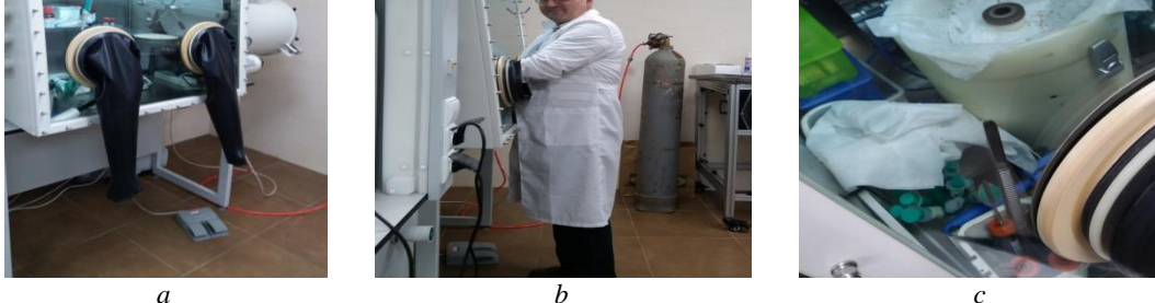
Fig. 9. (a, b) Instalația de depunere a fullerenui prin metoda “spin coating” în camera cu argon (c). Procesul de depunere a fullerenui
