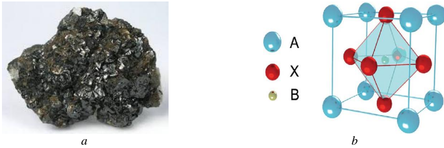
Fig. 3. Imaginaa rocii de perovskit (a) [9, p. 1]; Celulă Bravais cubică ideală (b) [10, p. 10491]
