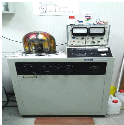
Fig. 3. Instalație de evaporare termică în vid
