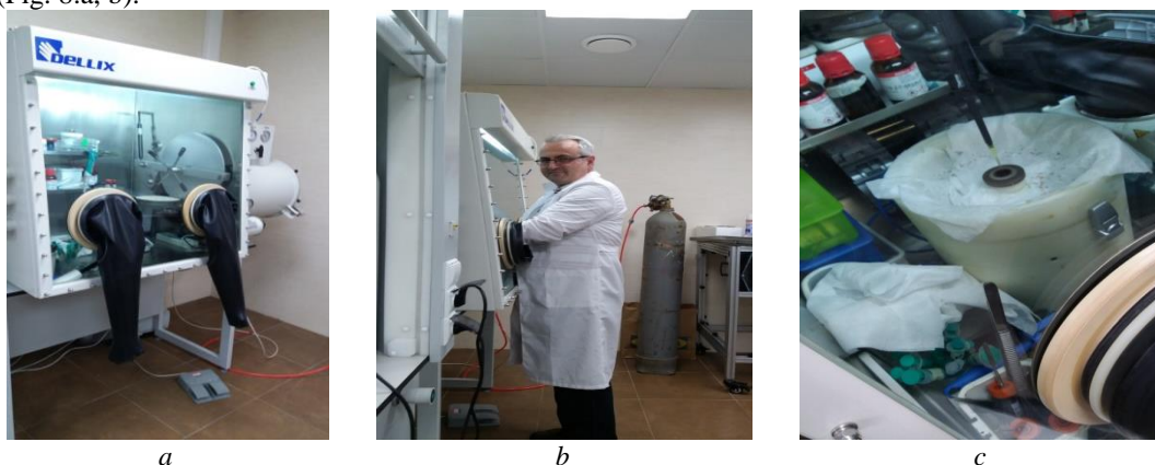
Fig. 9. (a, b) Instalația de depunere a fullerenui prin metoda “spin coating” în camera cu argon (c). Procesul de depunere a fullerenui
