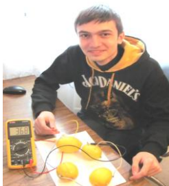
Fig. 2. Patru lămii conectate în serie dau o tensiune de 3,68-3,69V. Elevul clasei a XI-a, Procopovici Dumitru, în rol de experimentator. Liceul Teoretic „Mihai Eminescu” din Bălți, R. Moldova
