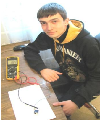
Fig. 7. Demonstrarea tensiunii electrice furnizate de bateria unui telefon mobil
