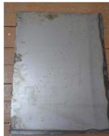
Figura 1. Format de tablă de ambutisare de 800x600x2 mm.
