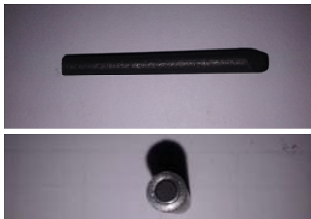
Figura 4. Vederea generală a electrozilor din grafit.
