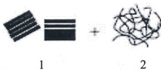
Fig. 1.1. Ranforsant (masa ceramică) (1); matrice polimerică (2).
