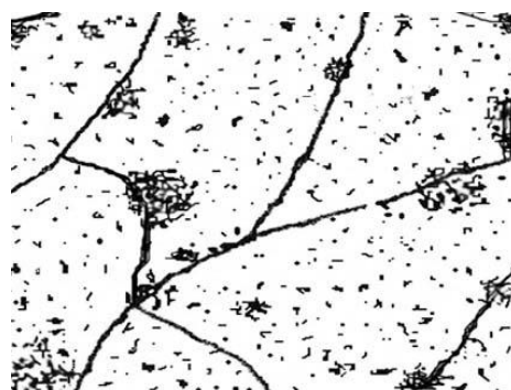
Рис. 7. Распределение азота 13 N в никеле после действия искровых разрядов в среде азота, l_{\text{МЭП}} = 0,5 мм, W = 2,7 Дж, \tau_1 = 200 мкс, \tau = 1 мин/см 2 , \times 4800
