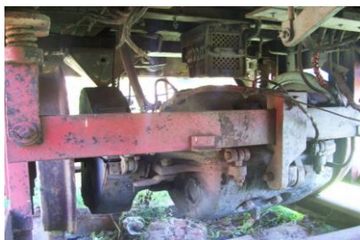
Figura nr. 3 Osia montata și motorul de tracțiune
