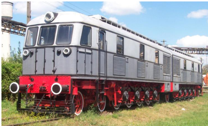
Figura nr. 4 Locomotiva diesel-electrica de 4400 CP
