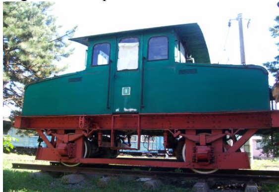
Figura nr. 1 Locomotiva electrică cu acumulatori
