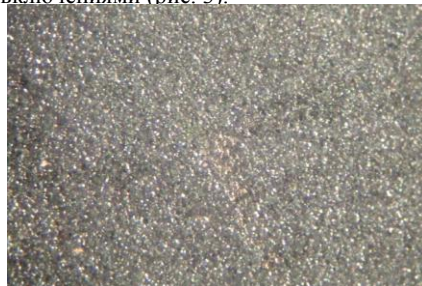
Рис. 4. Микрофотография поликристаллической пленки ZnO K-500x
