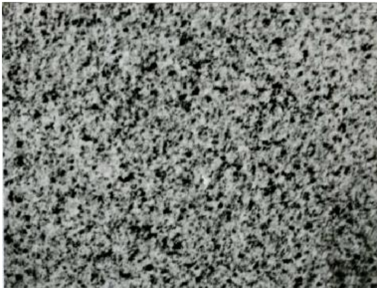
Fig. 2. Microfotografie TEM (scara 1:3000) pentru proba A.078 ( d = 7.8 \mu\text{m} , T_{sup} = 700^\circ\text{C} , r_d = 5 \mu\text{m/h} ).
