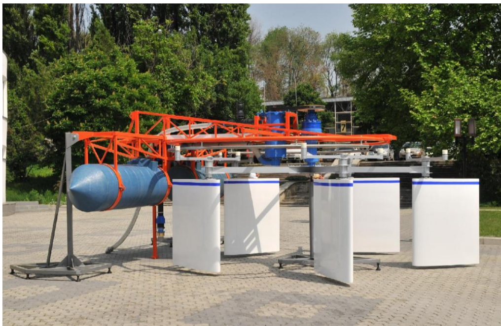
Fig. 4. Microhidrocentrală de conversie a energiei cinetice a apei.
