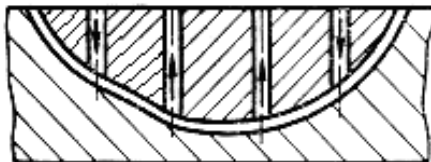
Fig. 3. Schema de copiere prin electroeroziune cu electrod masiv
