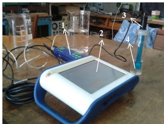
Fig.4. Instalația de determinare a concentrației ionilor de hidrogen: 1 – senzor multifuncțional, 2 – sistem de achiziții de date (SPARK SLS), 3 – electrocul pH, 4 – proba de analizat
