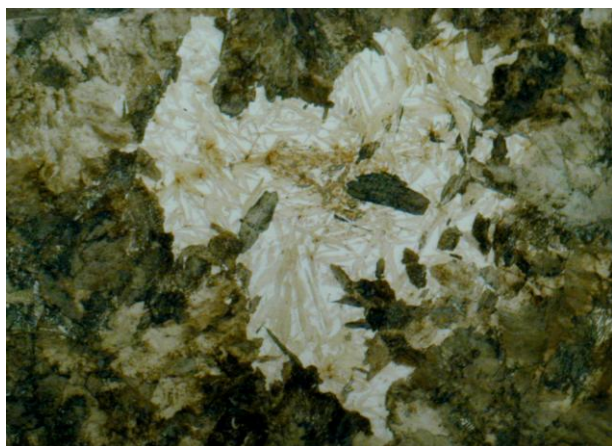
Рис. 2. Мартенсит в осевой зоне катанки диаметром 10 мм из стали марки С82D, \times 1000 .
