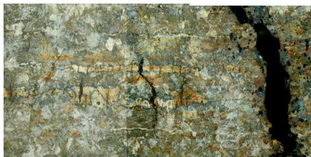
Рис. 3. Надрывы металла, совпадающие с мартенситными участками, в продольном сечении образца катанки, \times 200 .
