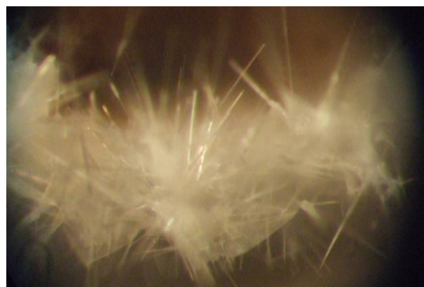
Fig. 5. Microstructuri cristaline filiforme de ZnO, obținute pe suprafața pastilei neprelucrate anterior termic.
