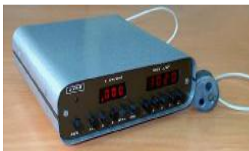
Fig. 5. Măsurătorul cu afișaj digital al radiației UV cu intensitatea în limitele valorilor 10^{-4} \div 2 \cdot 10 mW/m 2 ; domeniile spectrale, nm: 280÷400, 320÷400, 320÷360. Doza - 0 \div 1.6 \cdot 10^5 J/m 2 . Alimentarea - 220V
