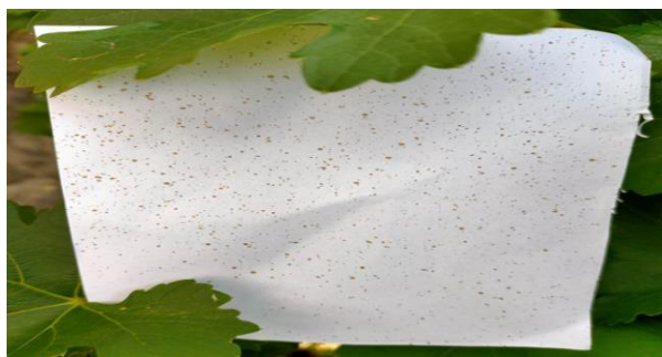
Fig. 3. Eficacitatea pulverizării și gradul de acoperire realizat cu ajutorul dronei a lotului de viță de vie.
