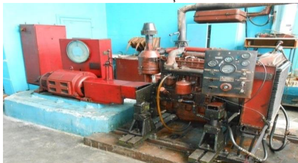
Fig. 1. Stand pentru încercarea motorului KI 13638 GOSNITI.
