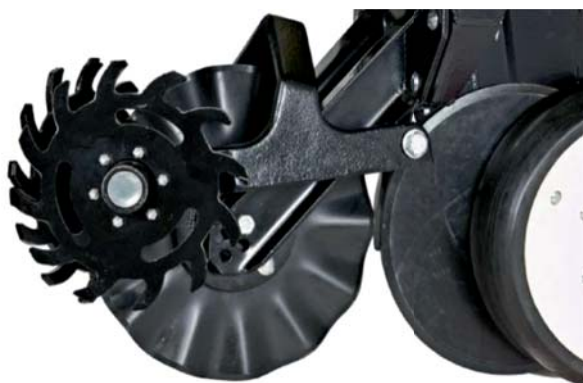
Фото 11.5. Очищающее оборудование, установленное на агрегате
