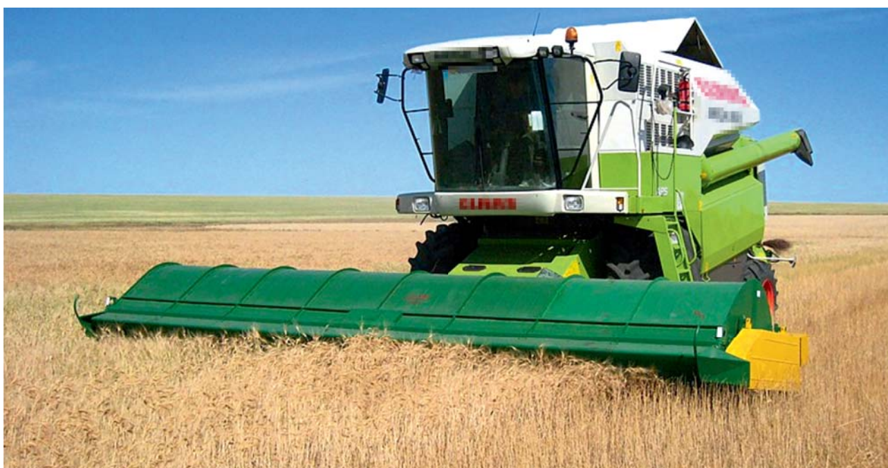
Фото 11.26. Комбайн оборудован очесывающей жаткой (stripper header)
