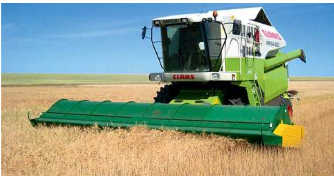
Foto 11.26. Combină echipată cu secerătoarea specială ( stripper header )
