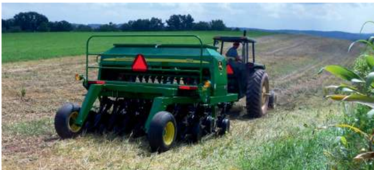
Foto 11.4. Semănătoarea cu brăzdare cu un disc
