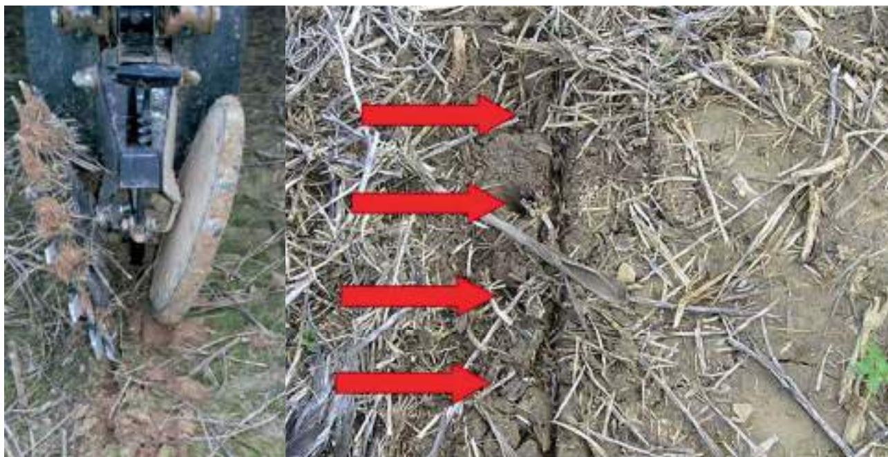
Foto 11.14. Set de roți combinat pentru o mai bună închidere a rigolei
