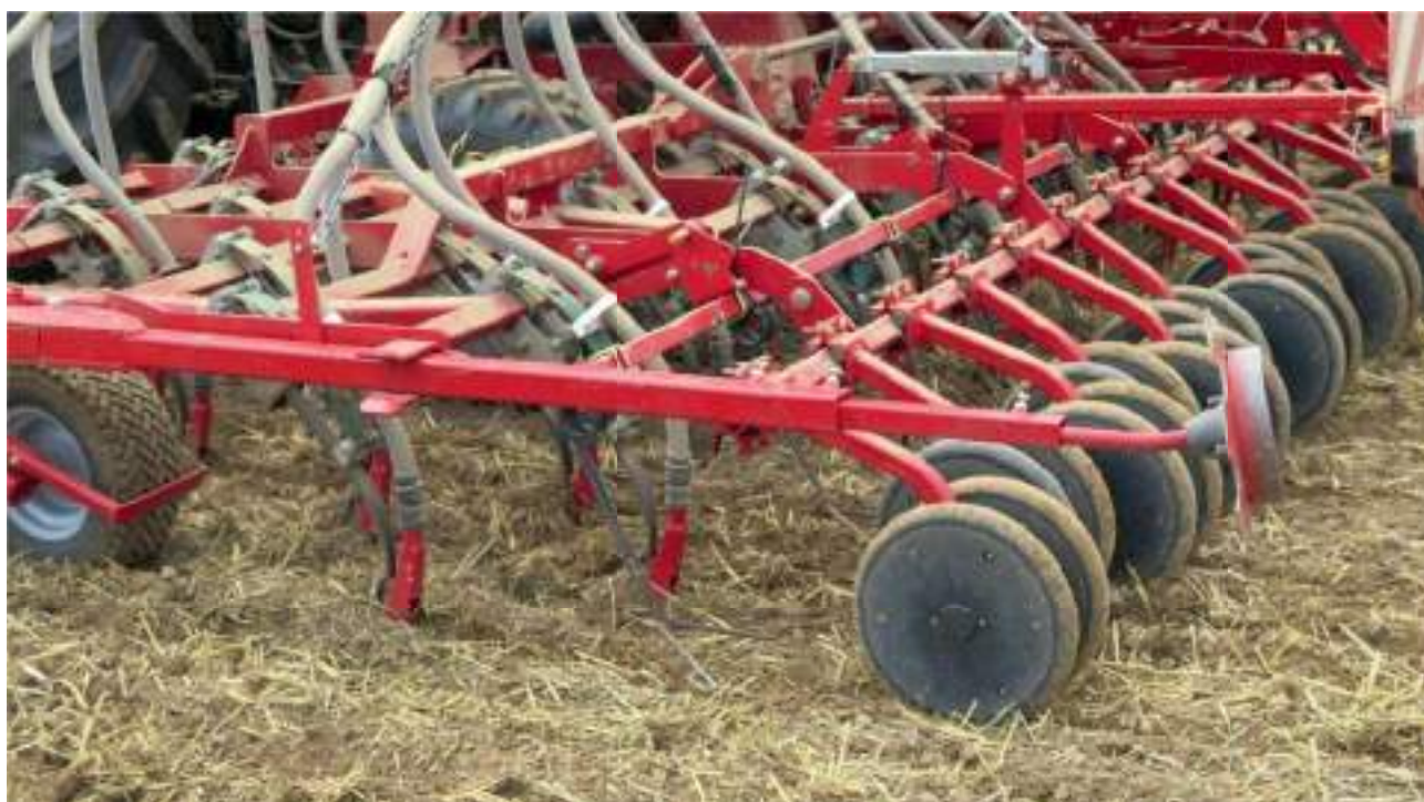
Foto 11.2. Semănătoarea cu brăzdar de tip daltă
