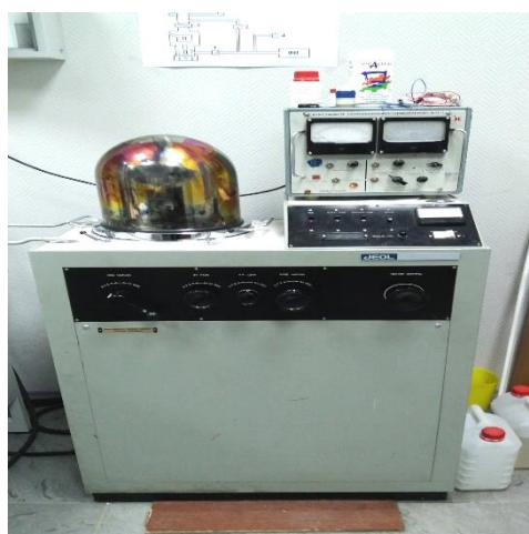
Fig. 3. Instalație de evaporare termică în vid
