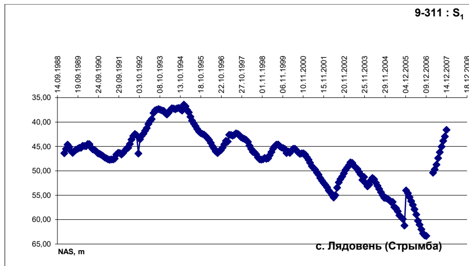
Рис. 3. Вариации уровня воды силурийского водоносного комплекса в с. Лядовень, Рышкаского р-на.
