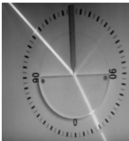
Fig. 7. Demonstrarea refracției luminii pe masa orizontală [9]
