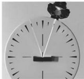
Fig. 1. Demonstrarea reflexiei luminii cu discul optic [2-4]
