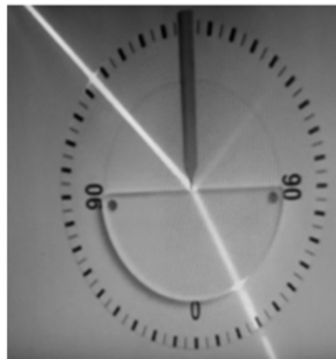
Fig. 7. Demonstrarea refracției luminii pe masa orizontală [9]
