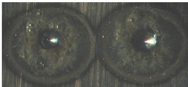
Fig. 4. Vederea generală a suprafeței piesei plane în urma prelucrării prin metoda descărcărilor electrice în impuls
