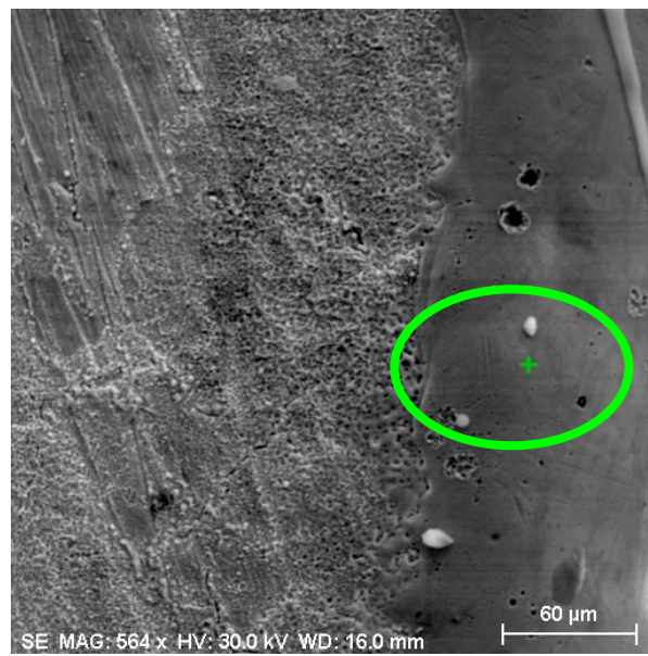
Fig. A.2.25. Analiza în punctul 1 (564x). Materialul probei – alamă JI63
