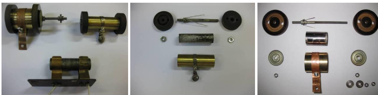
Fig. 5.1. Construcția pieselor componente la confecționarea rezistorilor prin formarea peliculelor de oxizi pe suprafețele metalice
