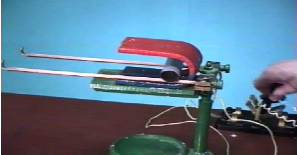
Fig. 5. Demonstrarea forței Ampere (cilindrul este deviat în dreapta)
