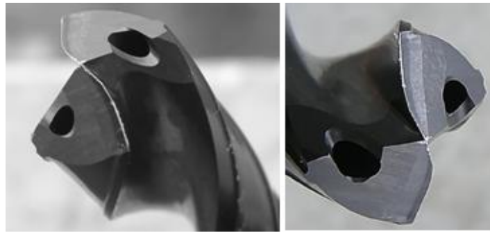
Fig. 7. Verschleiß der Hauptschneiden des Hartmetallbohrers \phi 11.03 H7 nach 50 m Gesamtlänge der bearbeiteten Bohrungen
