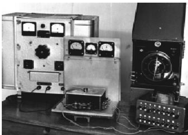
Рис. 4.1. Общий вид установки для определения остаточных внутренних напряжений:
