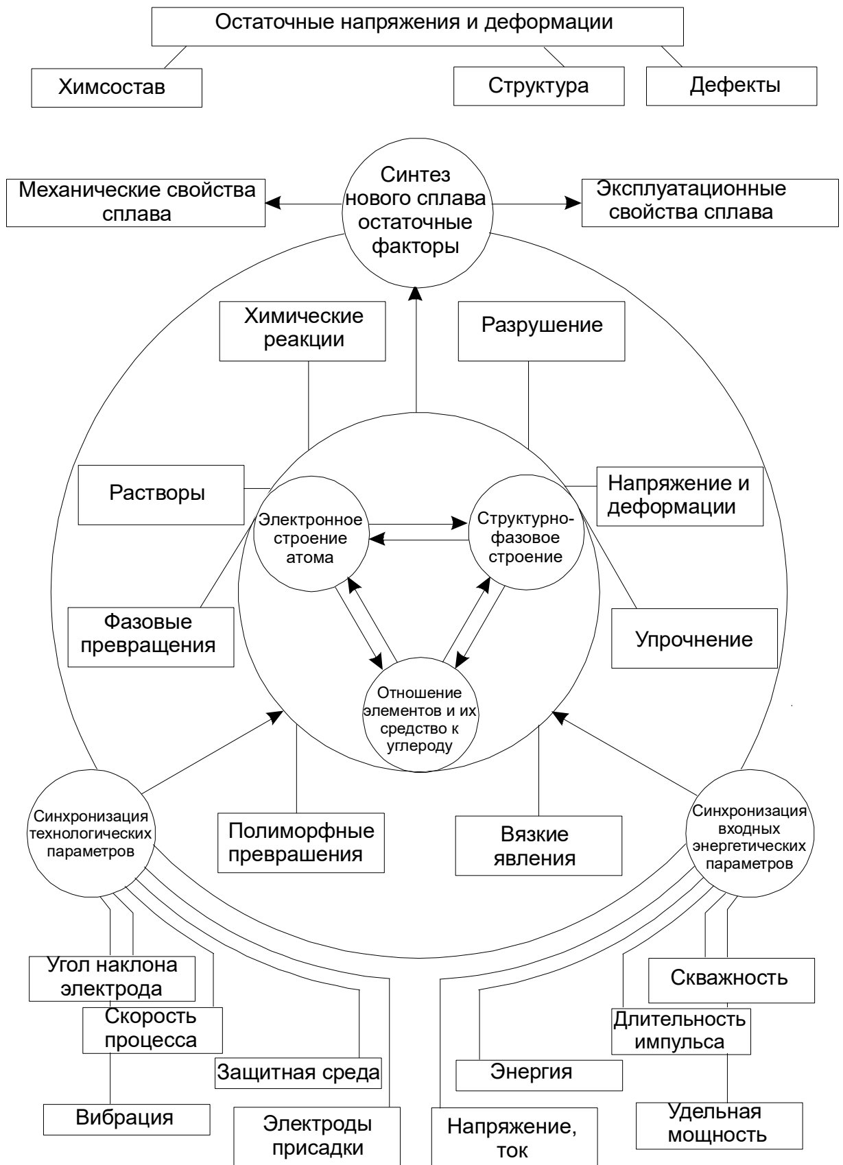
Рис. 4.26. Физическая модель технологического процесса электроискрового легирования
