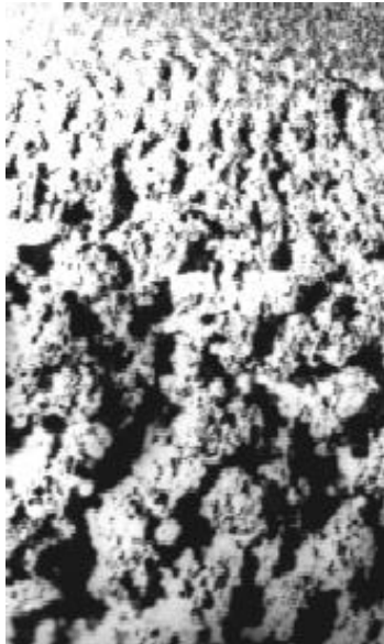
Рис. 3.3. Микроструктура белого слоя, полученного на вольфраме при электроискровом легировании его одноименным электродом (а) и на молибдене одноименным электродом (б) \times 500
