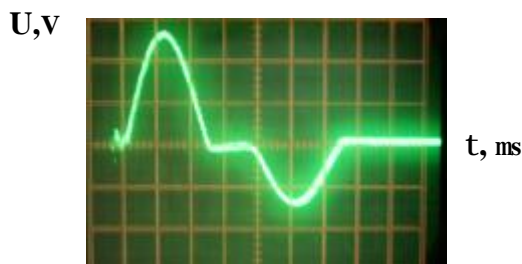
Fig.2. Vederea generală a oscilogramei obținută cu ajutorul sursei descrise mai sus în circuitul de descărcare: U_c=400V , S=1,5mm , C=8\mu F , f=3Hz .
