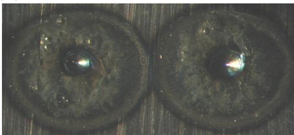
Fig. 4. Vederea generală a suprafeței piesei plane în urma prelucrării prin metoda descărcărilor electrice în impuls
